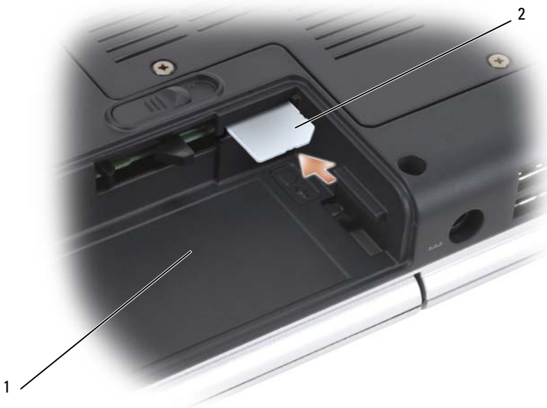
1 baie de batterie 2 SIM
