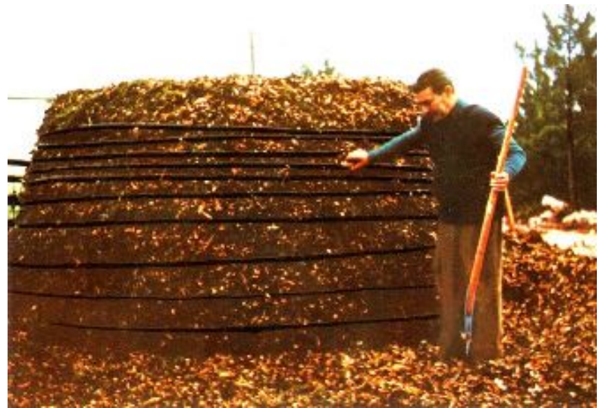
Mise en place du capteur qui, finalement, sera situé à l'intérieur du tas en construction
