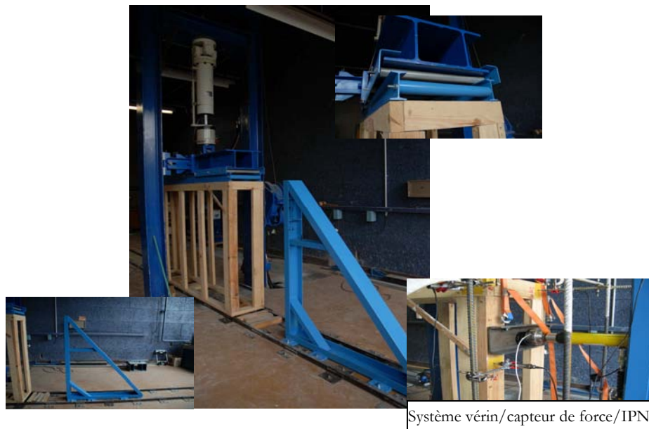
Figure 3.38 : Dispositif expérimental de caractérisation des structures G.R.E.B
