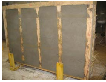
Figure 2.4 : Elément de mur après décoffrage
