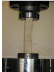
Figure 3.28 : Echantillon de Pin lors d'un test de R_c
